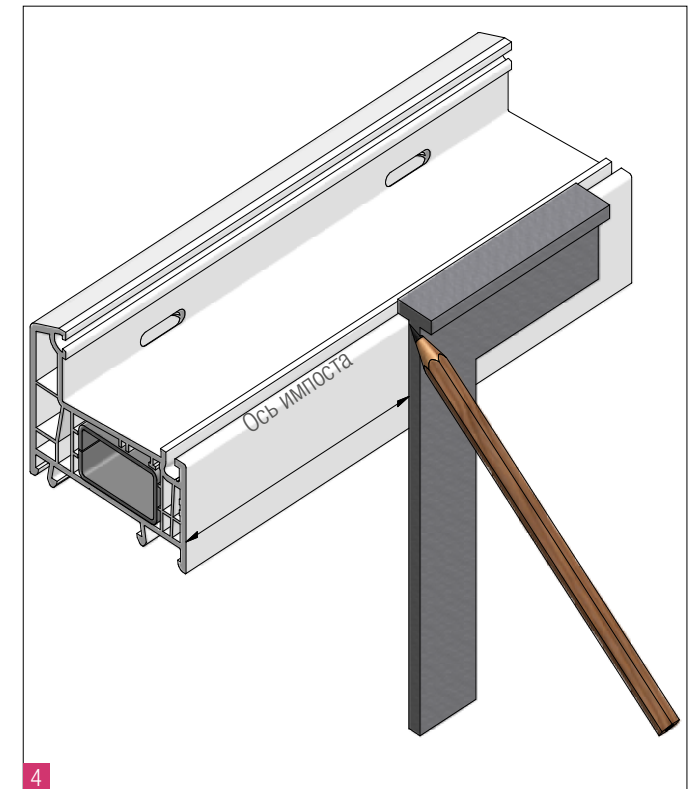
4 Разметить положение оси импоста (по возможности \geq 400 мм).
